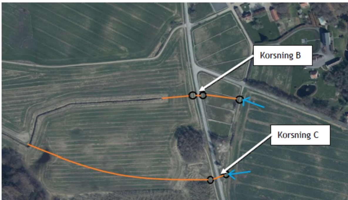
Figur 30 Dräneringsvatten från åkern leds västerut till Olstorpsån via två olika korsningar under väg 102. Orange linje anger kulverterad sträckning. Svarta cirklar visar synliga brunnar i ungefärligt läge. (Envidan AB, 2024)
